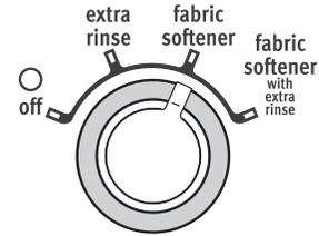
Esta lavadora ha sido diseñada para permitir el uso de una bola distribuidora de suavizante de telas, la cual usted deberá comprar. Siga siempre las instrucciones del fabricante acerca de las indicaciones correctas para usar la bola distribuidora. Luego seleccione la opción Fabric Softener (Suavizante de telas). La bola distribuidora de suavizante de telas liberará dicho suavizante durante el ciclo de enjuague.
