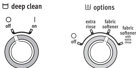
Si l'on souhaite ajouter l'option Deep Clean (nettoyage en profondeur), Extra Rinse (rinçage supplémentaire) ou d'autres options, tourner le bouton pour sélectionner l'option souhaitée ou le régler à ON (marche).
