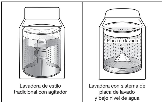
La mayor diferencia en su nueva lavadora es el sistema de placa de lavado y bajo nivel de agua. La lavadora regula automáticamente el nivel del agua de acuerdo al tamaño de la carga; no se necesita un selector de nivel de agua.
