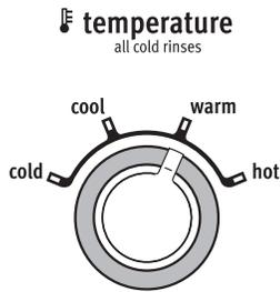
Una vez que haya seleccionado un ciclo, seleccione la temperatura de lavado deseada girando la perilla de Temperature (Temperatura) hacia el ajuste deseado.
