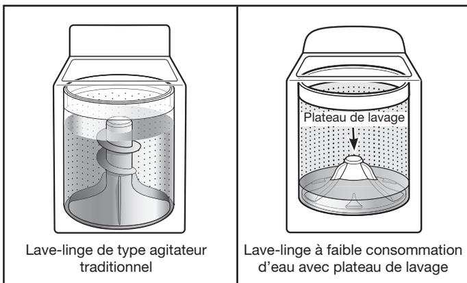
La nouveauté la plus remarquable de ce nouveau lave-linge est son système de lavage à faible consommation d'eau avec plateau de lavage. Le lave-linge ajuste automatiquement le niveau d'eau en fonction de la taille de la charge - nul besoin de sélecteur de niveau d'eau.
